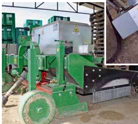
Le macchine utilizzate in azienda per il pirodisebbero e la sterilizzazione della fila e dell'interfila (nel particolare)
